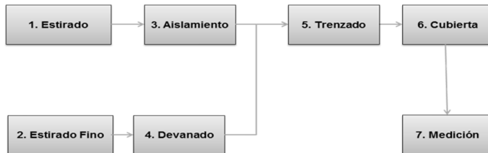
Diagrama del proceso de producción de cable coaxial
